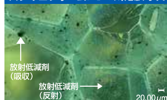
スタイロフォームFGの気泡膜写真
